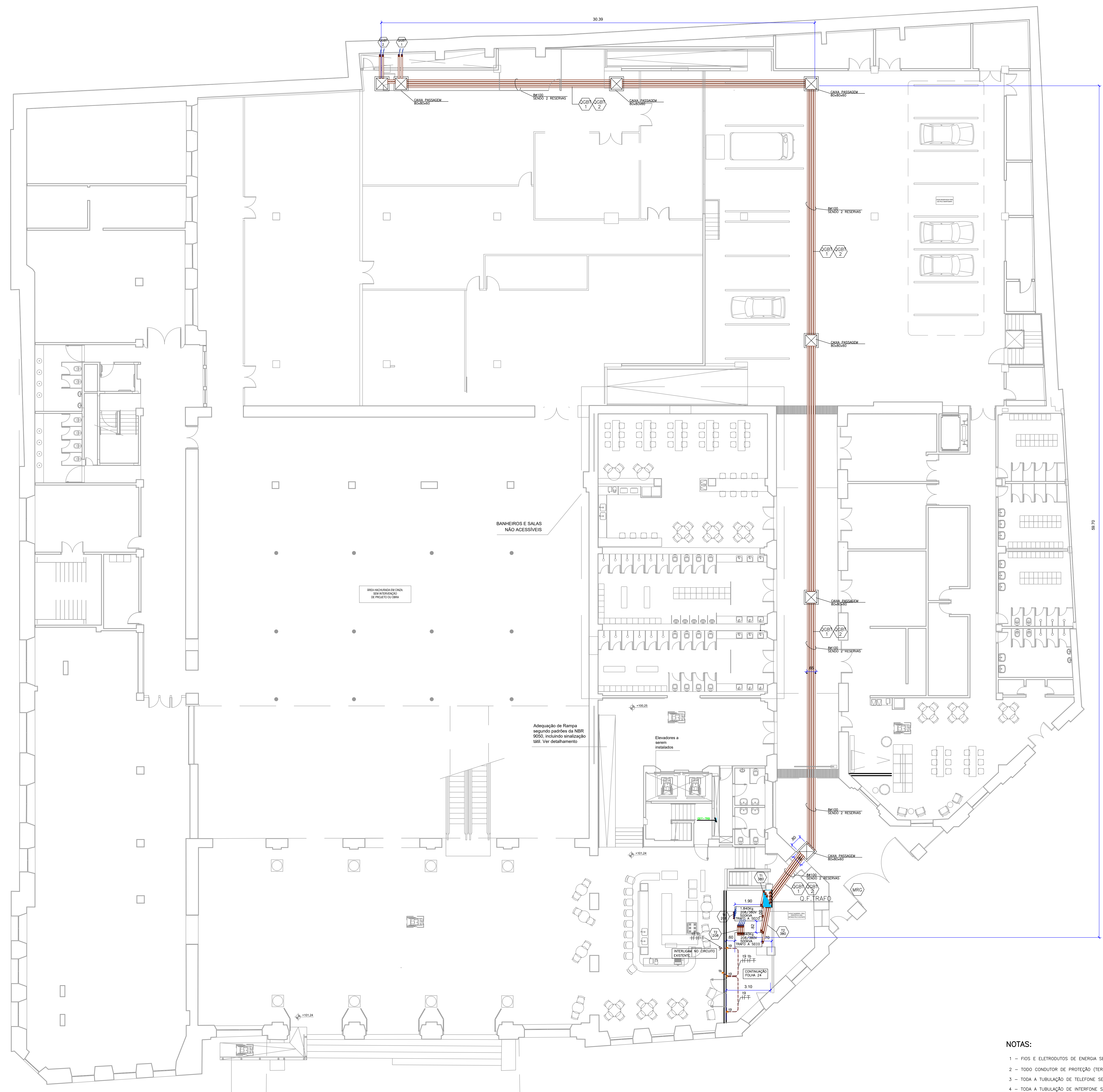
PAVIMENTO TERREO - SÃO JOÃO PLANTA DE TOMADAS E ALIMENTADORES ESC. 1:100
