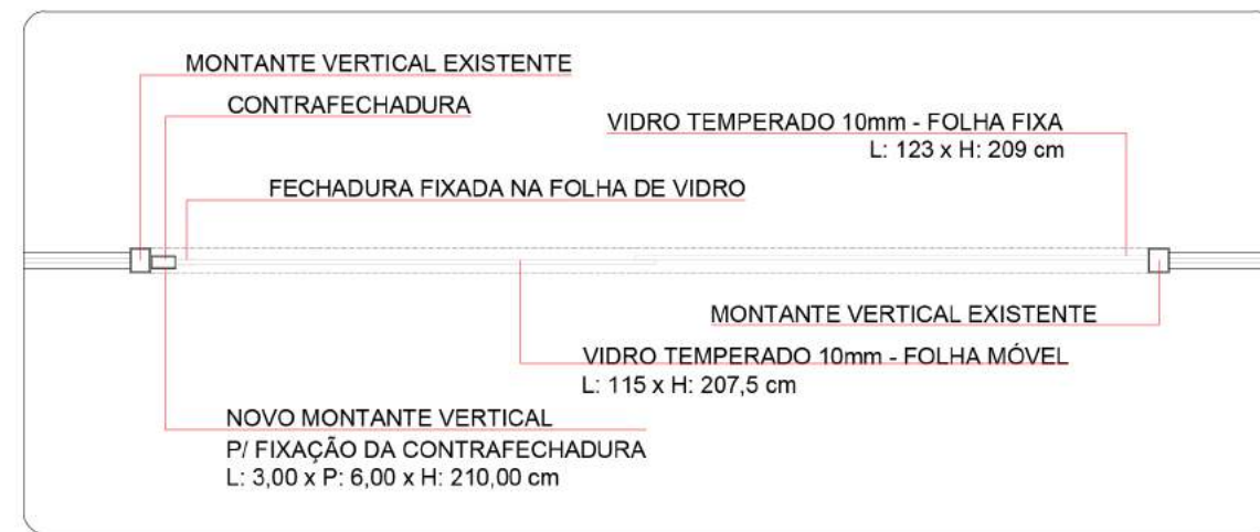
DET.1 PORTA DE CORRER - PLANTA ESC: 1/20
